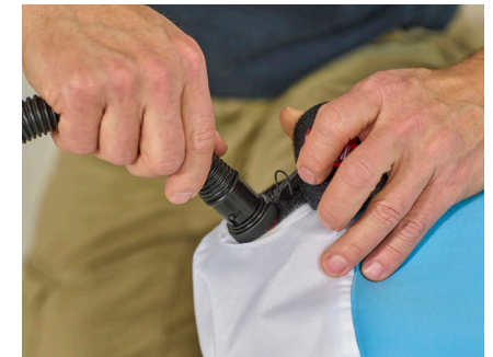
Foto 19: Slang met koppelstuk bevestigd aan ventiel.
