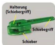
Abb. 3: Nicht beschädigter Reißverschlusschieber
